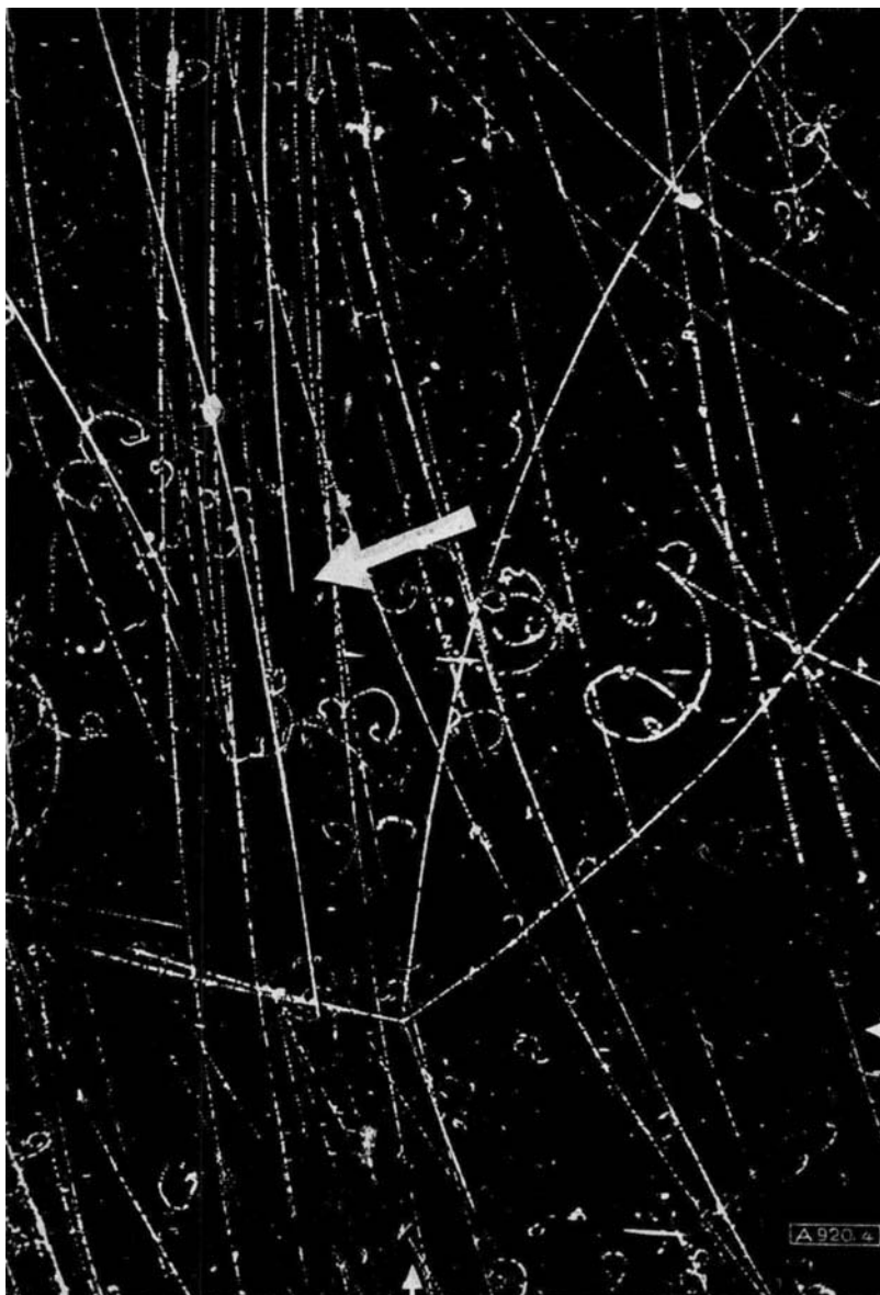
Abb. 4. Ein Antiproton trifft ein Proton (oberer Pfeil) und wird in ein Neutron-Antineutron-Paar transformiert. Das Antineutron vernichtet ein Nucleon (seitliche Pfeile). Propan-Blasenkameraaufnahme. (Physic. Rev. 110, 994 [1958])
